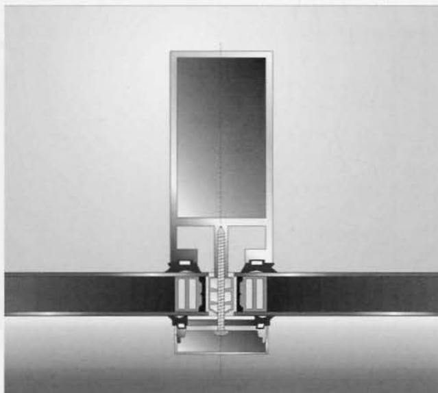
fig. 2-40 Coupe d'un système d'isolation pour façades
