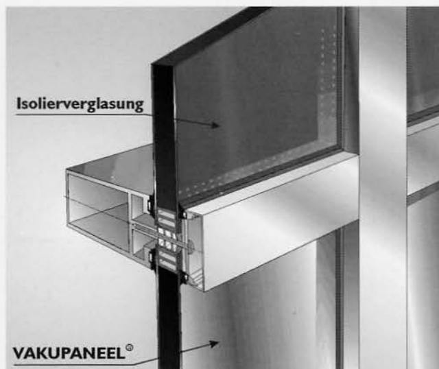
fig. 2-39 Façades poteaux-traverses isolées
